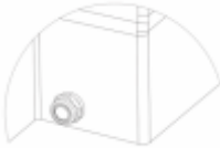
مهره کاسه نمددار برای تنظیم دریچه هوا بصورت ثابت
