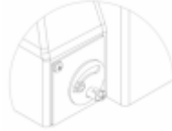
پیچ تنظیم دریچه هوا بصورت اتوماتیک
